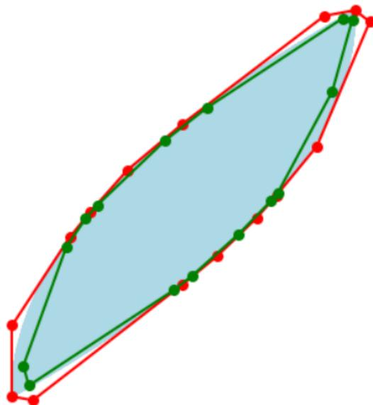
Figure – Approximation de l'ensemble atteignable avec 15 directions de  $p_f$
