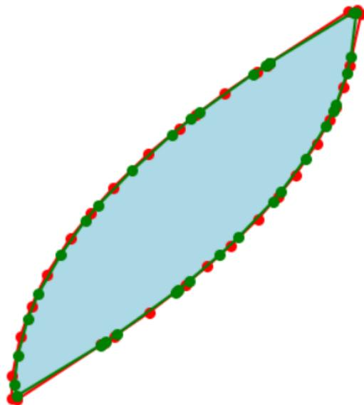
Figure – Approximation de l'ensemble atteignable avec 35 directions de  $p_f$
